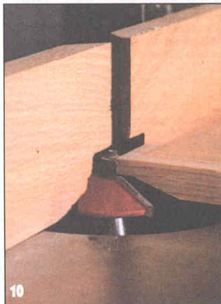
10 Филетки фрезеруют по контуру с обеих сторон.
