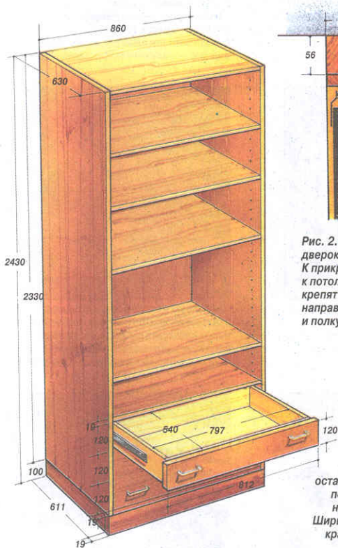
Рис. 1. Настенный стеллаж дает возможность использовать все пространство между стенами. Глубину и высоту его выбирают по желанию. Ширина закрытых секций шкафа зависит от ширины дверок; размер открытой секции — от длины стены, вдоль которой устроен шкаф. Здесь ее ширина составляет 82,2 см.
