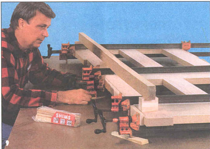
Затем выставляют горизонтально и боковые элементы обвязки, по возможности устраняя их провисание в середине.
