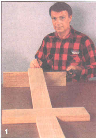
Раскладывают перемычки и средники.
