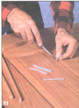
11 Прокладки из вспененного материала между филетками и рамой устраняют дребезжание филенок и центрируют их.
